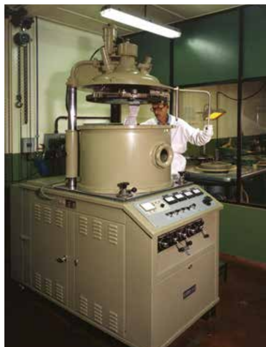
▲ Macchina sotto vuoto per la metallizzazione degli specchi con deposito di uno strato di pochi millesimi di alluminio polverizzato per ottenere la loro superficie riflettente.
