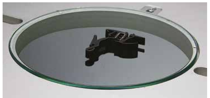
Misurazione di pezzo complesso, appoggiato su piano lettura senza orientamento. Measurement of an involute composite piece on the glass worktable with no reference points.
